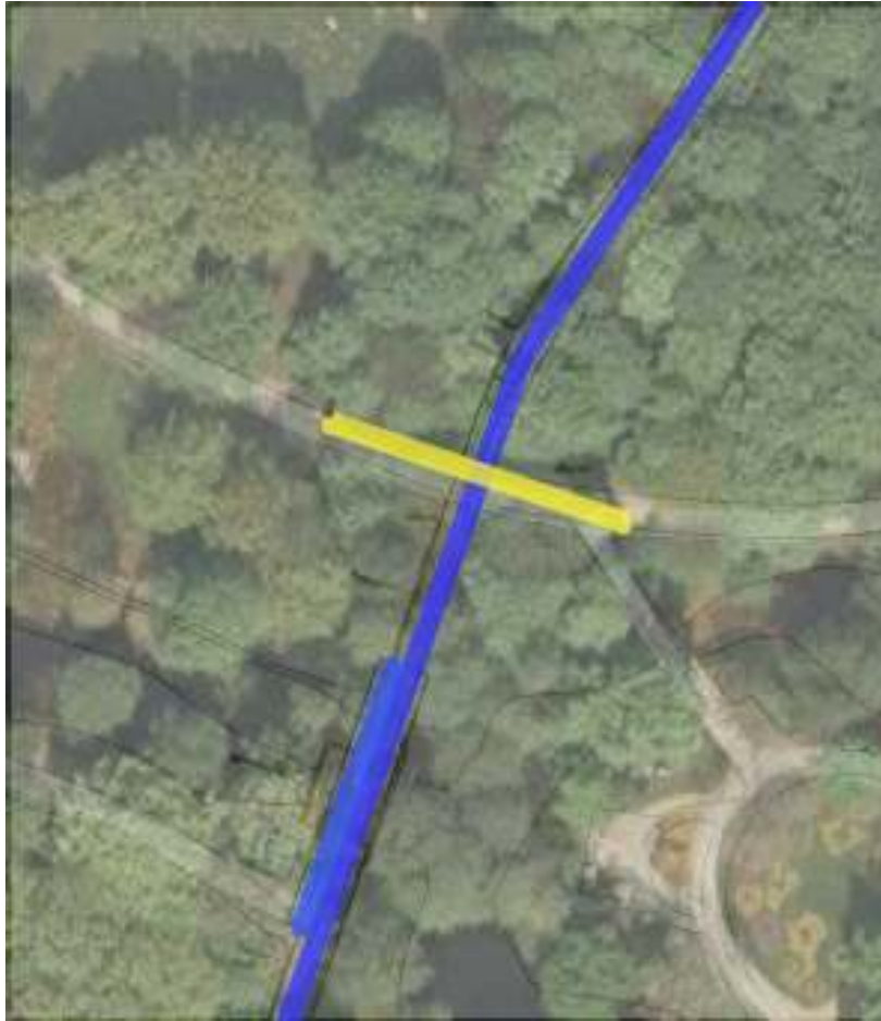
Luftbild: EK380_2, 380 kV-Erdkabeltrasse, sie verläuft 1,9 m unter dem Parkweg, nur an der Brücke liegen die Kabel nebeneinander 0,5 m unter dem Asphalt (X)
