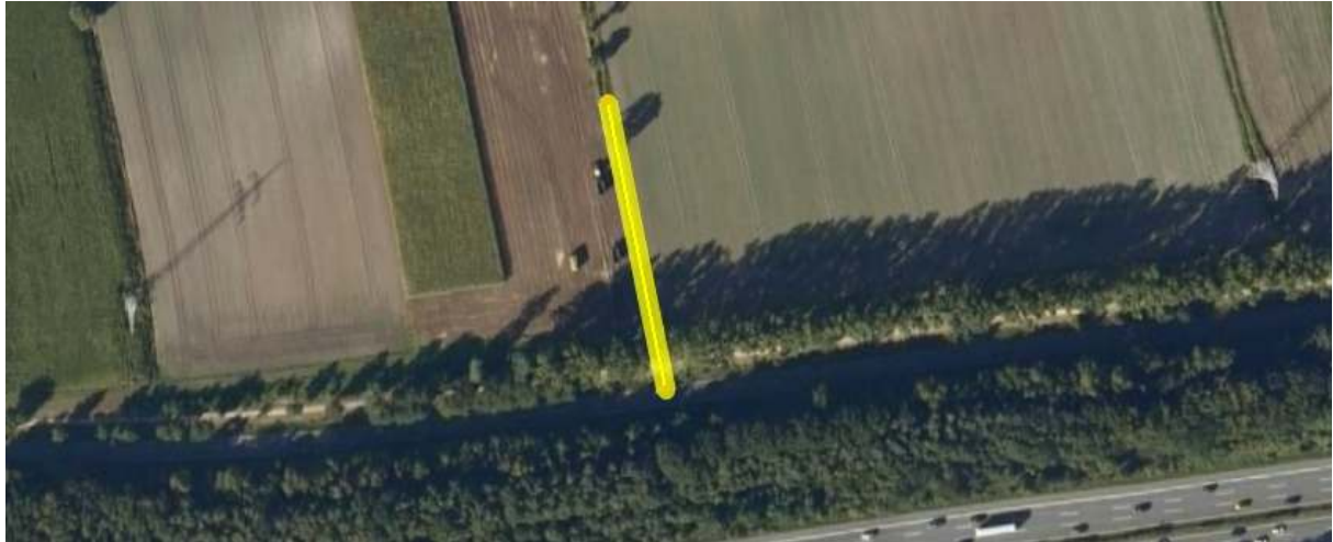
Luftbild: FL110_3, 110 kV-Freileitung, der Messweg verläuft auf dem Ackerrandstreifen, der die Trasse kreuzt
