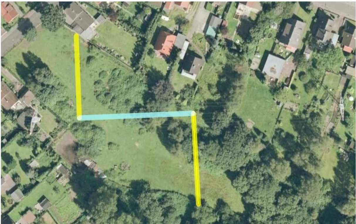
Luftbild: FL110_1, 110 kV-Freileitung, das Querprofil musste geteilt werden, die beiden Teil-Querprofile (QP-S und QP-N) wurden durch ein Längsprofil (LP) in Trassenmitte verbunden (die im Verlauf des Messweges auf dem Luftbild erkennbaren Bäume und Büsche waren während der Messung nicht mehr vorhanden, vgl. Foto)
