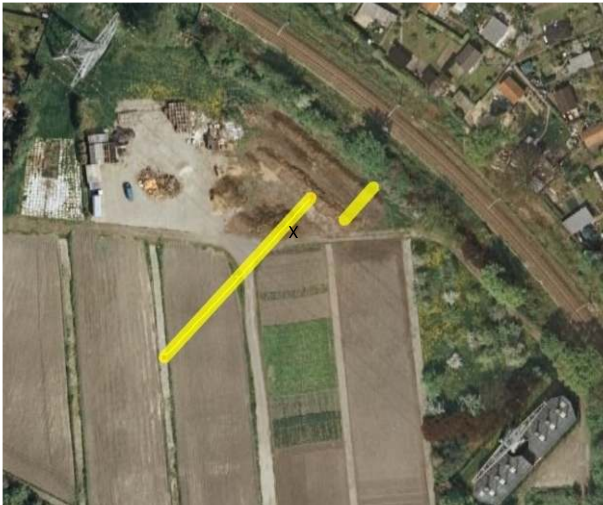
Luftbild: FL380_5, 380 kV-Freileitung, wegen unbegehrbarer Hindernisse musste der Messweg geteilt werden (Trassenmitte: X)
